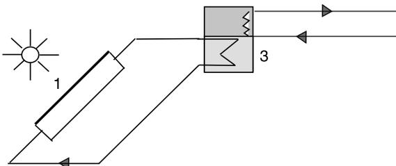
Fig. 6. Thermosyphon DHW system.
